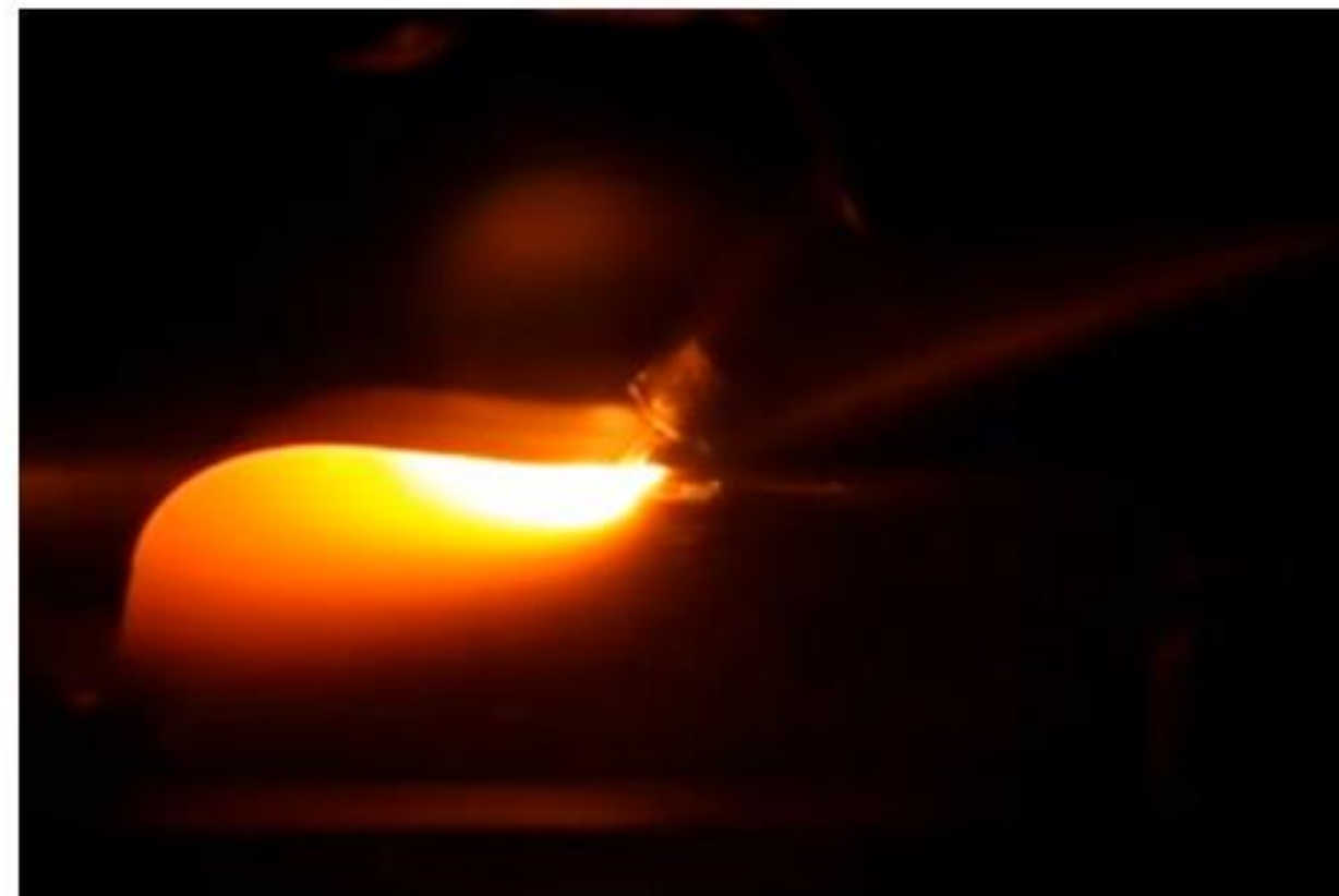
Рисунок 2. Процесс печати образца из Al-Si12
